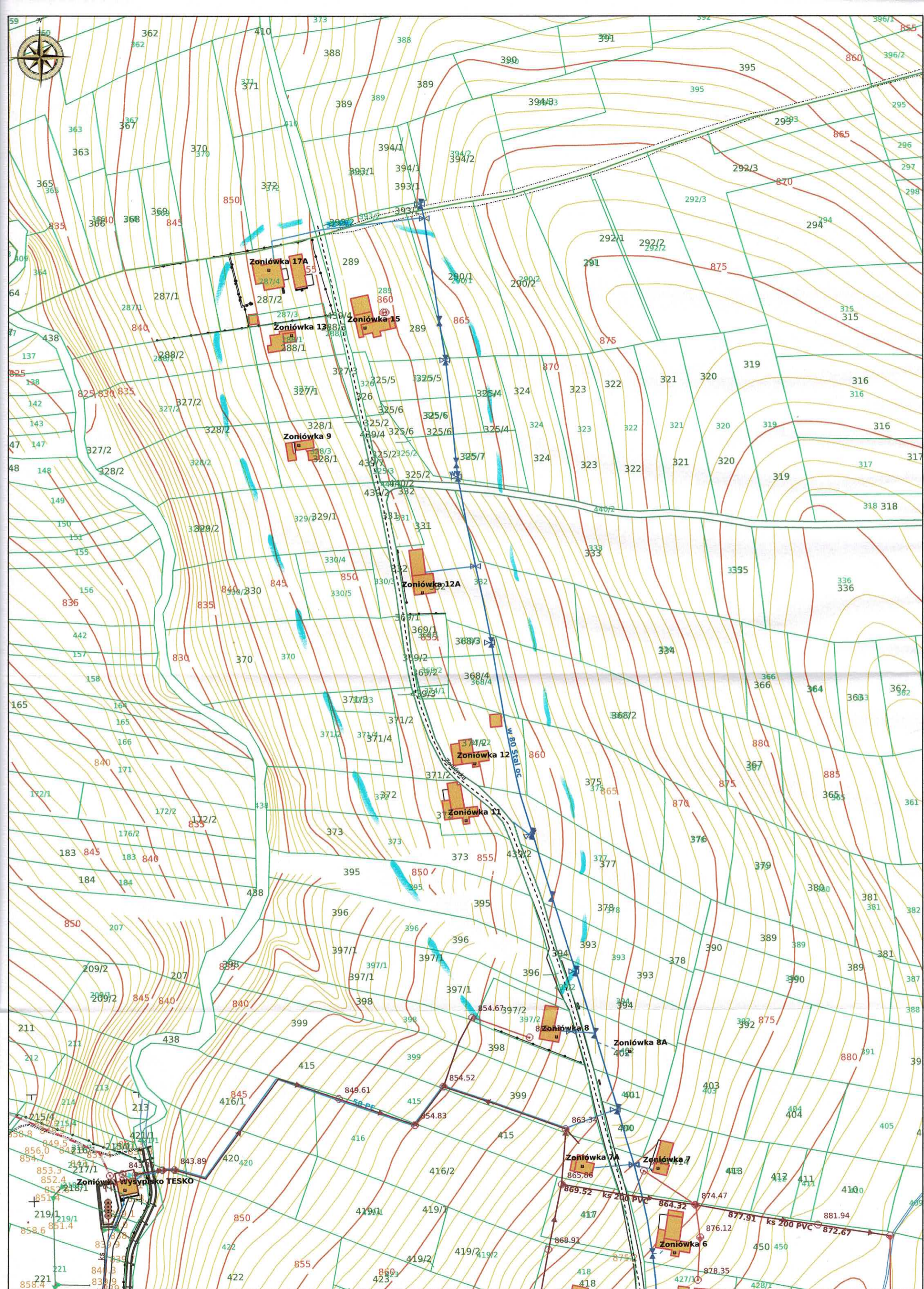
OBSZAR PRZEZNACZONY DO WYKONANIA KAN. SANITARNEJ 1:1500
